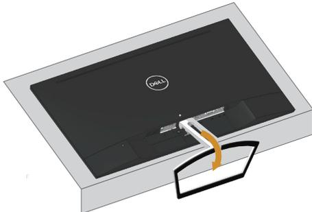
3. Drücken Sie die Freigabetaste mit einem langen Schraubendreher.
